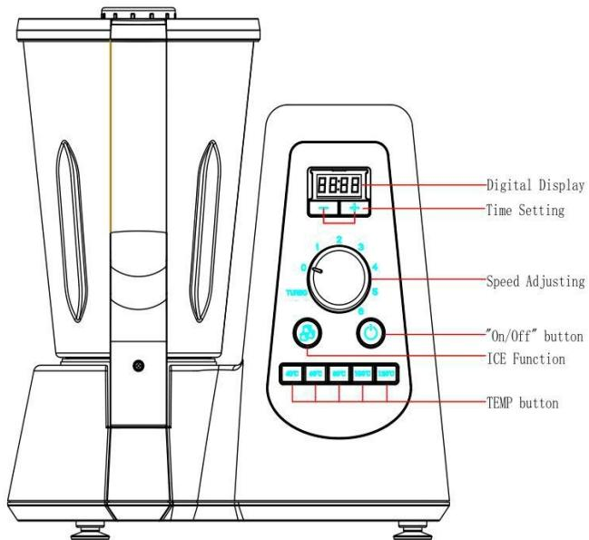
1. Вкл/Выкл : нажмите кнопку «Вкл/Выкл» для входа в режим ожидания; данная кнопка запускает работу устройства, включает режим ожидания, используется для остановки устройства;
